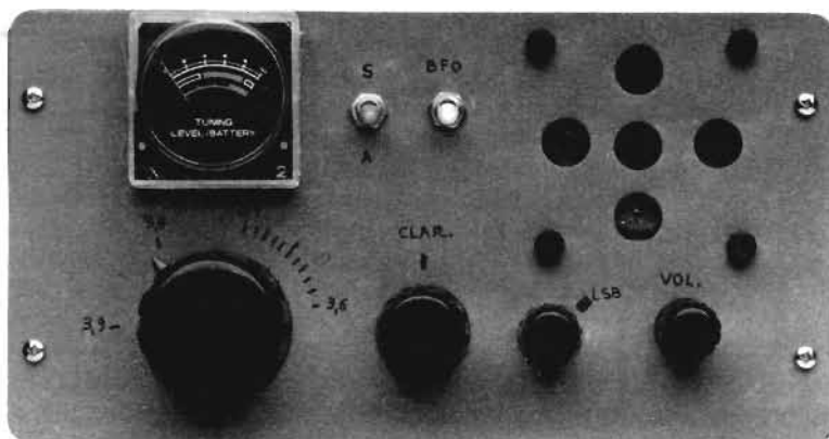
Fig. 9 - Riproduzione fotografica del pannello frontale del ricevitore per onde corte. In corrispondenza dell'altoparlante, la lamiera del contenitore è abbondantemente forata, allo scopo di favorire la fuoriuscita delle onde sonore.
