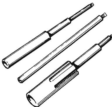
Fig. 5 - Questi sono gli speciali cacciaviti che il dilettante ed il professionista impiega in tutte le operazioni di taratura e messa a punto di apparecchiature elettroniche. Il corpo dell'utensile è di materiale isolante, plastica o ambra, e soltanto sull'estremità operativa è presente una piccola lama d'acciaio.
